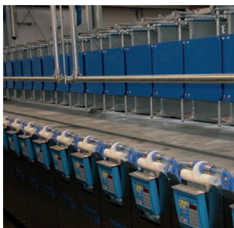
Na het melken staan alle melkbekers automatisch in de reinigingspositie
