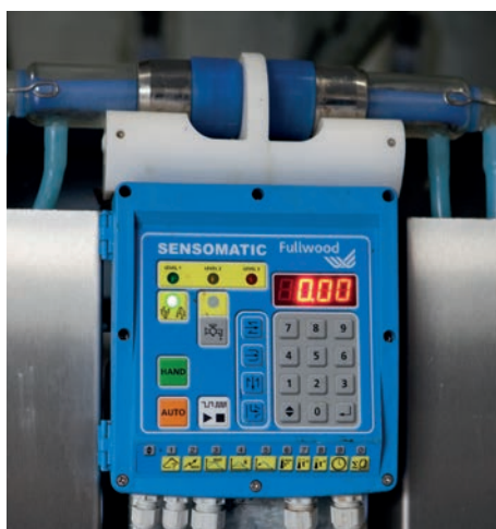
Een sensor monitort de reiniging per stand
